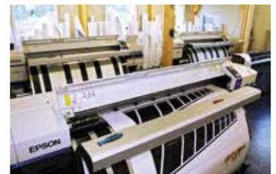
Der Transfer-Thermosublimationsdrucker „Epson SC-F6000“ bei einem Werbetechnikunternehmen, wo er hauptsächlich zur Produktion von Funktionstextilien zum Einsatz kommt.
