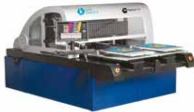
für hohe Produktionsvolumina. Wenn es um Sonder- oder Markenfarben oder einen erweiterten Farbumfang geht, steht die „Hexa“ zur Verfügung. Mit den beiden zusätzlichen „Neo Pigment“-Tinten für Rot und Grün lassen sich besonders farbintensive Textilien kreieren.
